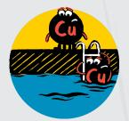
Reactivos colectores: Tienen la función de hacer que las partículas de cobre y molibdeno hagan todo lo posible por rechazar el agua. Su objetivo es generar una conducta "hidrófoba" (fobia al agua) en el mineral para que este se separe del agua e ingrese a las burbujas de aire.
