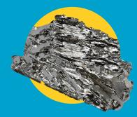
El molibdeno es un elemento metálico que no se encuentra en estado puro en la naturaleza, por lo que se extrae de otros materiales, como por ejemplo, los minerales sulfurados. Se usa, principalmente, en la fabricación de acero gracias a su gran resistencia a la temperatura y corrosión.
