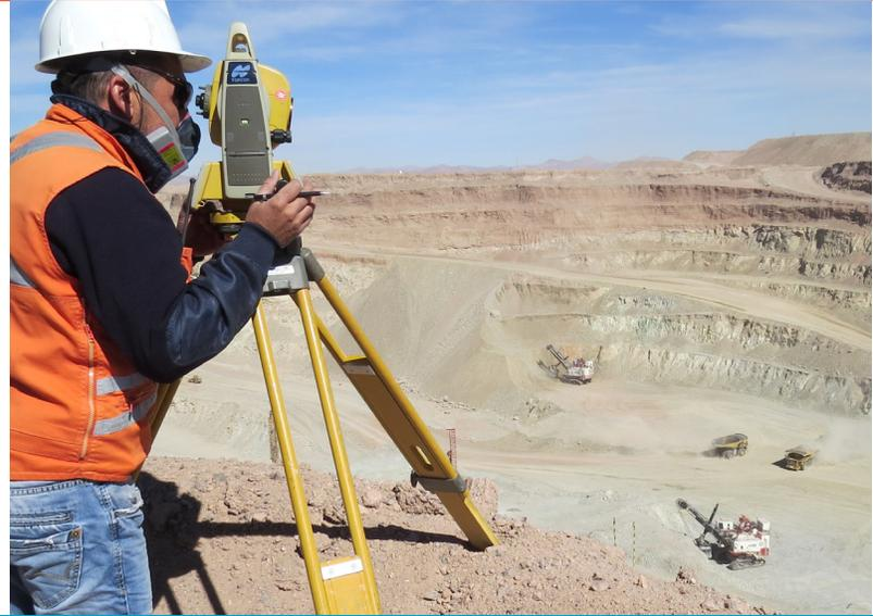
Por su parte, el **levantamiento topográfico** corresponde al conjunto de operaciones que se utilizan para determinar las posiciones de puntos en la superficie de la Tierra -tanto en planta como en altura-, incluyendo los cálculos correspondientes y la representación en un plano, ya sea horizontal como verticalmente.
